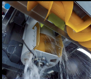
Système de lavage vis sans fin verticale
