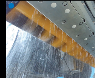
Système de lavage vis sans fin horizontale
