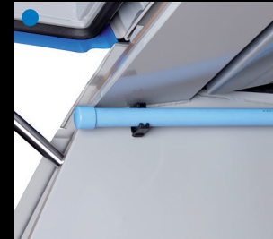
Système de lavage benne à neige
