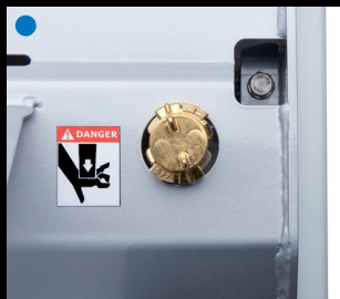
Station de lavage de la vis verticale
